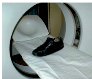
► Figure 6: Measurement of shoes with a human CT unit ► Bild 6: Schuhmessung mit einem Human-CT-Gerät
